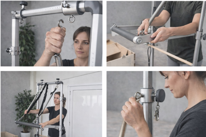
Abb. 4 — Seil durch die Umlenkrollen einfädeln
